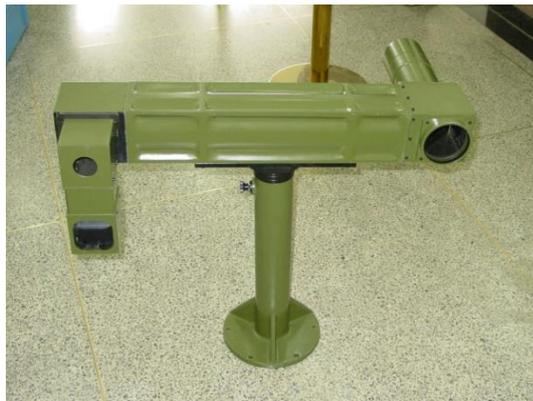
分束法采用的光轴平行性测试仪
